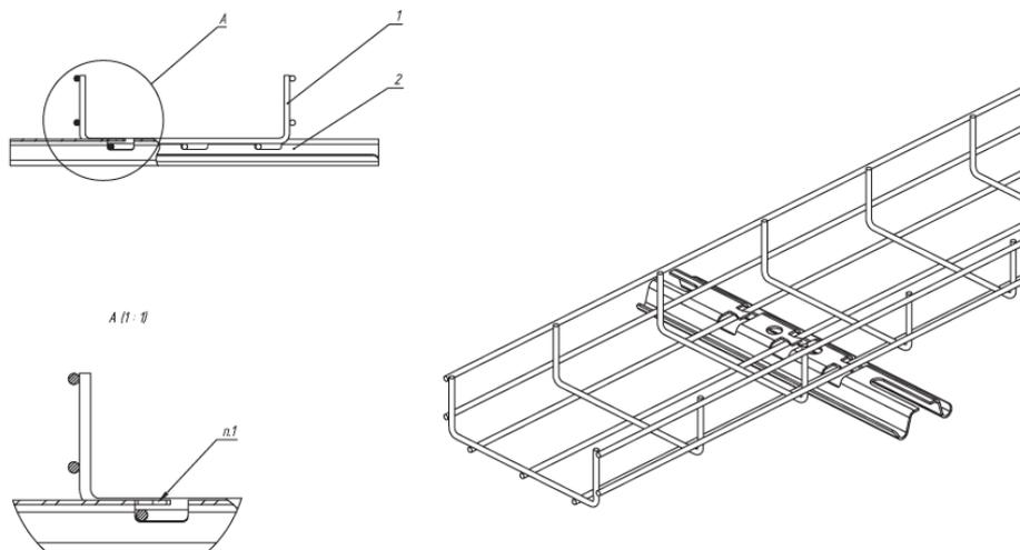
Крепление лотка к потолку или шпильке производится при помощи Омега профиля. Для организации подвеса на основе шпилек применять анкер латунный или стальной забивной М6-М10, в котором закрепляется шпилька М6-М10. Омега профиль закрепляется в шпильке с помощью гайки с фланцем М6-М10. Далее необходимо совместить основание лотка и пазы кронштейна и закрепить лоток, загнув крепежные лепестки кронштейна внутрь.
