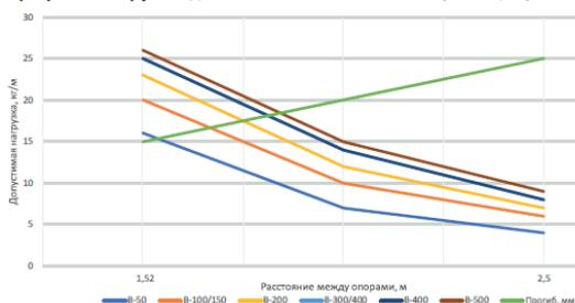
Графики нагрузок для лотков высотой 30 мм, толщ. 4,8 мм
