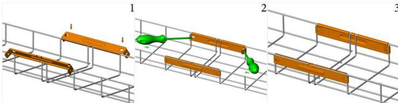
Для сборки каждого стыка используется 2 соединителя вкв.
