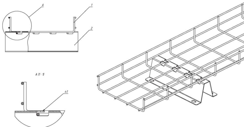
Крепление лотка к стене или полу производится при помощи кронштейна настенно-напольного. Для этого необходимо зафиксировать кронштейн на стене с помощью анкерных болтов с гайкой М8х85. Далее необходимо совместить основание лотка и пазы кронштейна и закрепить лоток, загнув крепежные лепестки кронштейна внутрь.
