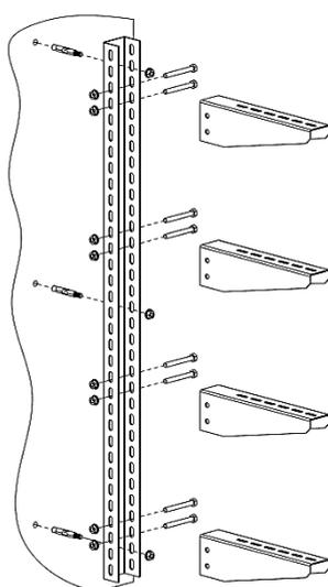
Крепление лотка к стене производится при помощи П-образного профиля. Для этого необходимо прикрепить профиль к стене с помощью анкерных болтов с гайкой М8х85. Кронштейн монтажный закрепляется в профиле с помощью болта шестигранного М8х70 и гайки с фланцем М8. Далее необходимо совместить основание лотка и перфорацию консоли в двух местах и через них закрепить лоток и консоль с помощью винтового комплекта соединительного одинарного 6х20.
