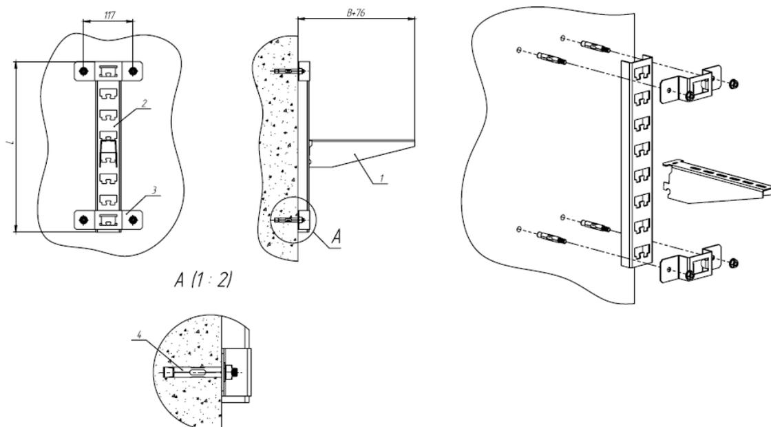
Крепление лотка к стене производится при помощи скобы кабельной. Для этого необходимо зафиксировать стойку кабельную на стене с помощью скобы, которая фиксируется болтом анкерным с гайкой М10х75. Далее необходимо совместить основание лотка и перфорацию консоли в двух местах и через них закрепить лоток и консоль с помощью винтового комплекта соединительного одинарного 6х20.
