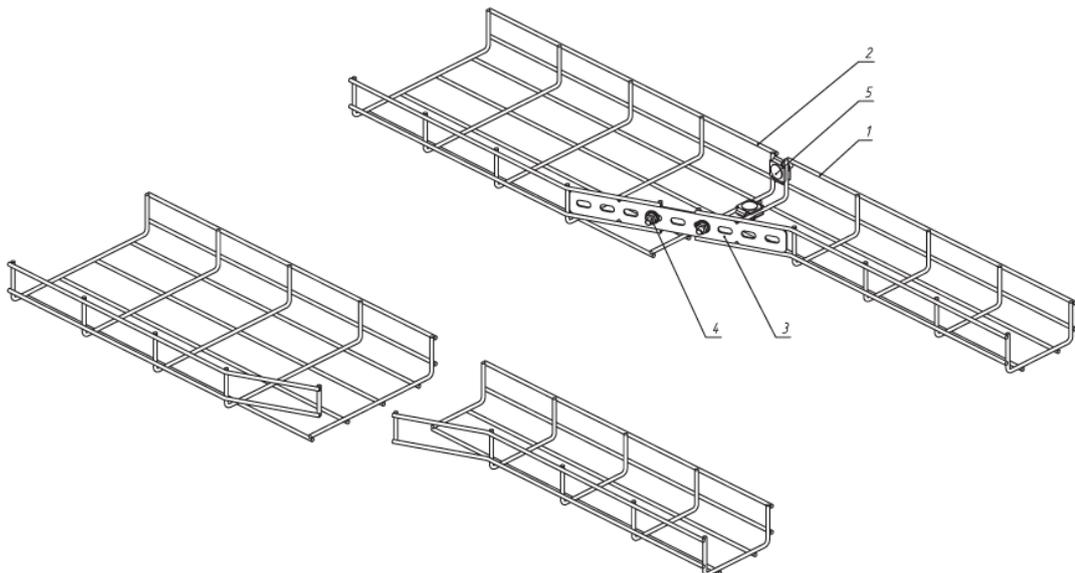
Для выполнения перехода по ширине удалить сгиб в основании проволочного лотка на боковой стороне, отогнуть боковую стенку внутрь. Повторить действия на другом лотке, с отгибом боковой стенки наружу. Закрепить стенки перехода лотка с помощью перфорированного соединителя рср и комплекта соединительного одинарного вско.
