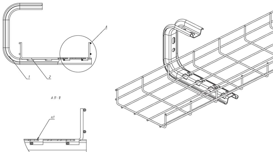
Крепление лотка к потолку или шпильке производится при помощи С-омега профиля. Для этого необходимо зафиксировать профиль на потолке с помощью анкера латунного/стального забивного М10, болта шестигранного М10х50, шайбы плоской М10. Далее необходимо совместить основание лотка и пазы кронштейна и закрепить лоток, загнув крепежные лепестки кронштейна внутрь.
