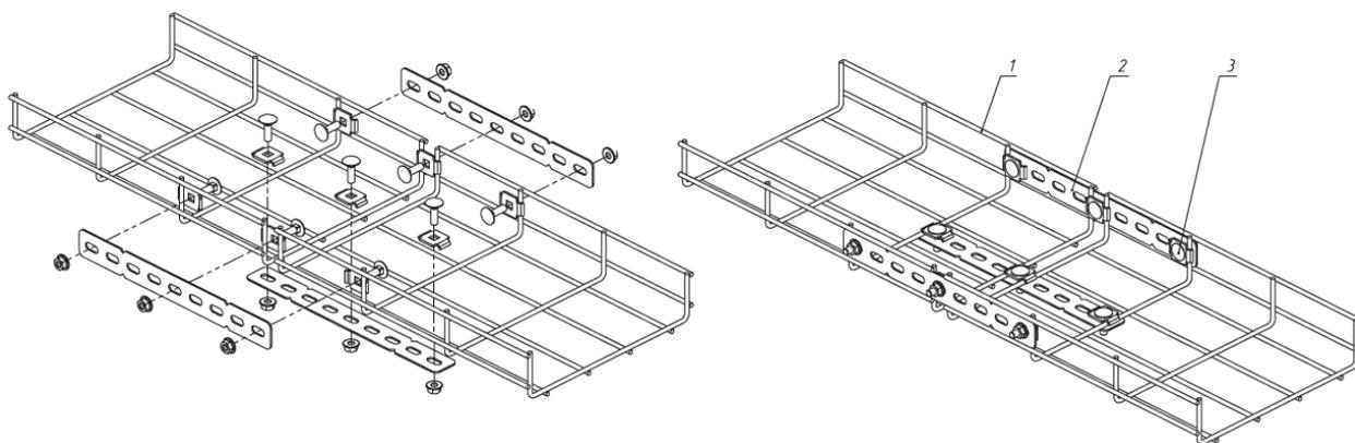
7.2.3 Соединение встык с помощью безвинтового соединителя bvc
