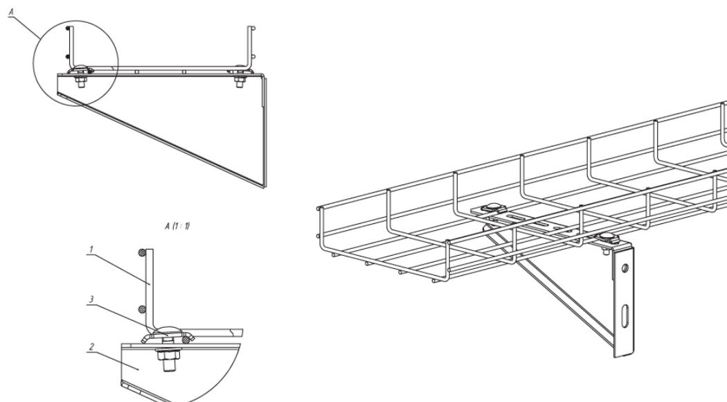
Крепление лотка к стене производится при помощи кронштейна настенного. Для этого необходимо зафиксировать кронштейн на стене с помощью анкерных болтов с гайкой М10х75. Далее необходимо совместить основание лотка и перфорацию консоли в двух местах и через них закрепить лоток и консоль с помощью винтового комплекта соединительного одинарного 6х20.
