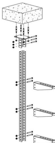
Далее необходимо совместить основание лотка и перфорацию консоли в двух местах и через них закрепить лоток и консоль с помощью винтового комплекта соединительного одинарного 6х20.
