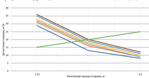
Графики нагрузок для лотков высотой 50 мм, толщ. 4,8 мм
