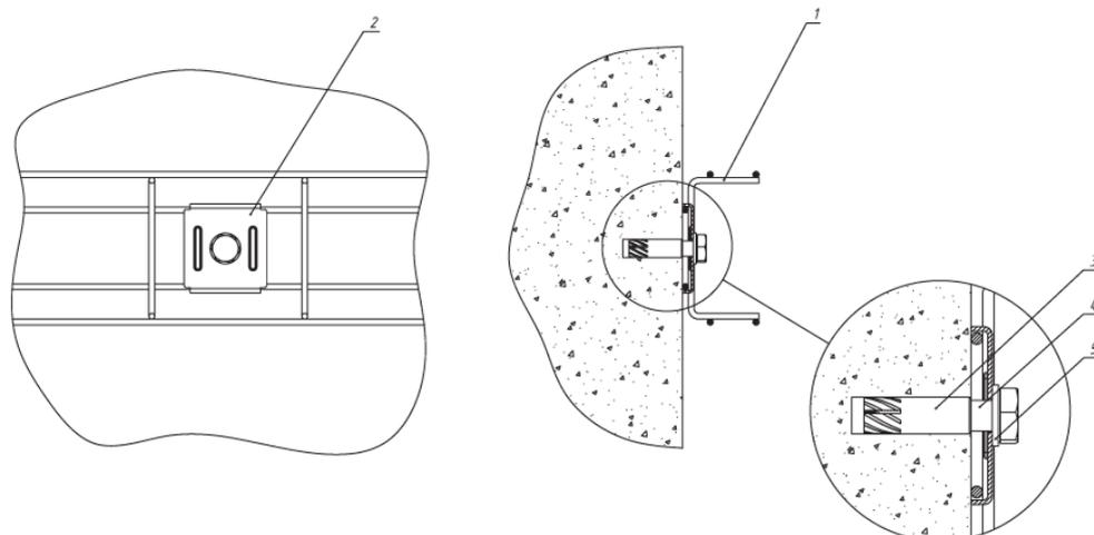
Крепление лотка к стене производится при помощи фиксаторной площадки. Для этого необходимо зафиксировать площадку на основании лотка, а на стене фиксировать с помощью анкера стального /латунного забивного М10, болта шестигранного М10х40 и шайбы плоской М10.
