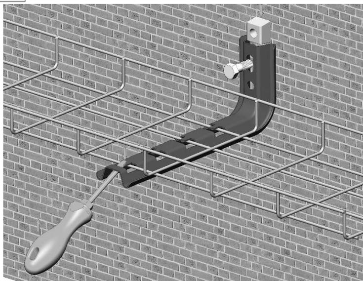
Крепление лотка к стене производится при помощи L-омега профиля. Для этого необходимо зафиксировать профиль на стене с помощью анкера латунного/стального забивного М10, болта шестигранного М10х50, шайбы плоской М10. Далее необходимо совместить основание лотка и пазы кронштейна и закрепить лоток, загнув крепежные лепестки кронштейна внутрь.
