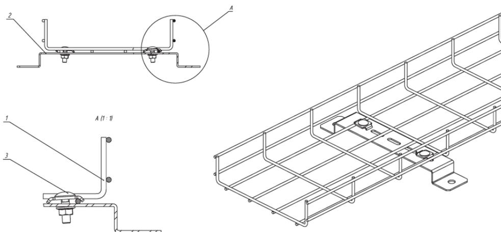
Крепление лотка к стене или полу производится при помощи скобы подвеса нижней. Для этого необходимо зафиксировать скобу с помощью анкерных болтов с гайкой М8х85. Далее необходимо совместить основание лотка и перфорацию скобы в двух местах и через них закрепить лоток и скобу с помощью винтового соединительного комплекта одинарного vско.
