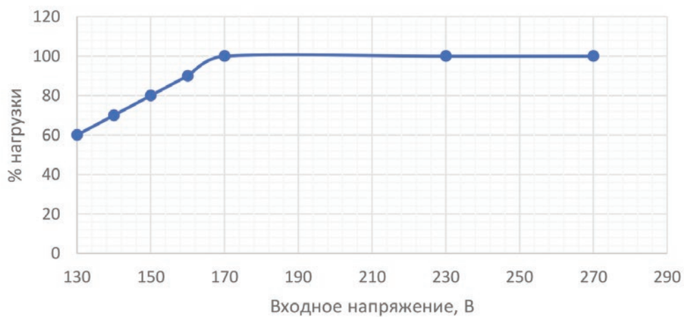
Рис. 6. Зависимость мощности нагрузки от входного напряжения
